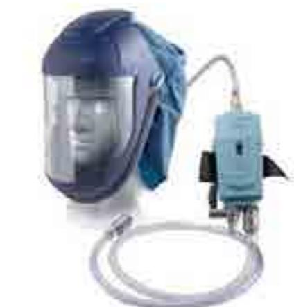
Quest'ultimo ha la funzione di depurare definitivamente l'aria da condensa ed odori prima di essere immessa nella visiera (F). Nella parte superiore del portafiltro è posizionato il regolatore di flusso (G), che assicura un flusso regolare di aria all'interno della visiera di 180 l./minuto. Il diffusore posto all'interno della visiera distribuisce uniformemente l'aria.
