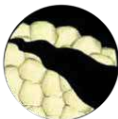
Frattura abrasivo Sol-Gel / Sol-Gel abrasive fracture
