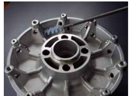
Scovoli per sbavare cerchioni in lega / Twisted-in brushes for wheel rims deburring
