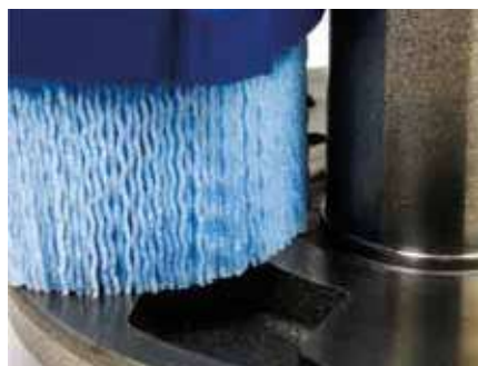
Spazzola a disco per la finitura di stampati in ghisa / Disc brush for cast iron finishing
