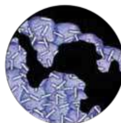
Frattura abrasivo ceramico speciale / Special ceramic filament fracture
