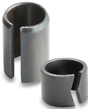
Le ghiere elastiche offrono una soluzione conveniente per proteggere parti macchina soggette a usura e corrosione in ambienti scarsamente lubrificati. Vengono prodotte da laminati in acciaio per molle bonificati e sono adatti per applicazioni con basso numero di giri ad alto carico specifico o dove si producono movimenti oscillanti a bassa frequenza.
