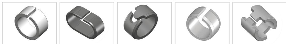
Vengono inserite a pressione in fori già esistenti sul componente plastico in modo manuale o automatico. Il diametro esterno è maggiore rispetto al diametro nominale del foro e, grazie ad una fenditura e alle sue caratteristiche elastiche, sono in grado di inserirsi perfettamente nel foro e sviluppare una forza radiale tale da rimanere bloccate senza danneggiare il componente che li ospita.
