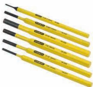
· In acciaio al cromo vanadio, temprato per ulteriore durezza. Per fare tacche prima di forare ed estrarre perni. Sezione ottagonale. Verniciatura a polvere di grande visibilità.
