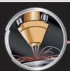
Il carburo di tungsteno viene depositato sulla lama con un laser ad alta potenza
